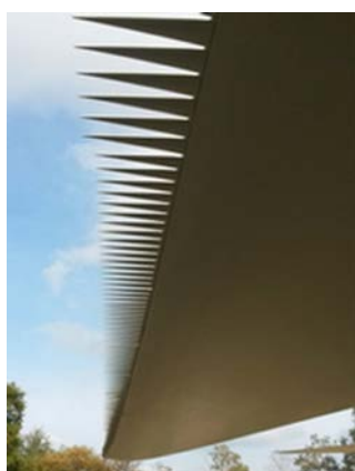
Figure 25: Photo de serrations sur une pale d'éolienne
